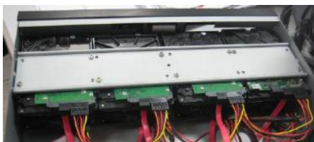
Рис. 2.1 Подключение жесткого диска
