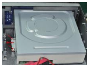
Рис. 2.2 Подключение пишущего DVD
