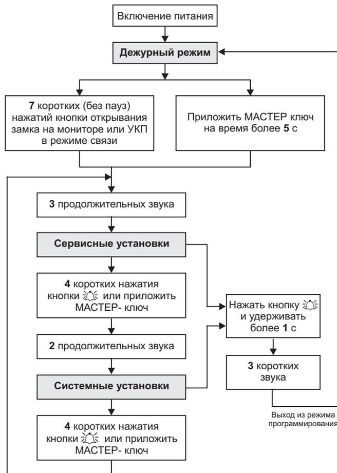
Рисунок 6 - Диаграмма переходов между системными и сервисными установками
