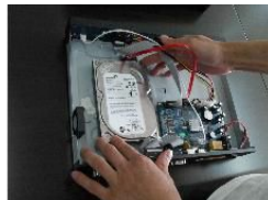
③ Подключите HDD кабелями к плате
