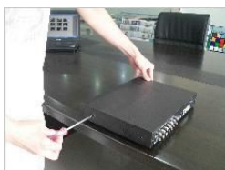
① Открутите винты на корпусе
